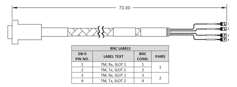
Figure A-9. DB-9F to 4X BNC G.703 S1 / S2 TMI Data Cable (CEFD P/N CA-0000703)
