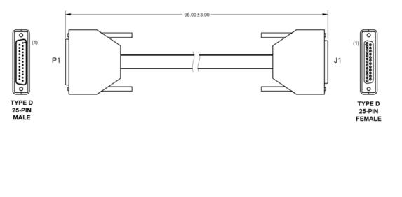
Figure A-2. CRS-500 CSU → DSU Control Cable (CEFD P/N CA-0000234)
