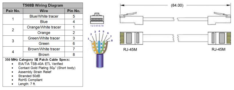
Figure A-6. Ethernet Data Cable (CEFD P/N PP/CAT5FF7FTGY)
